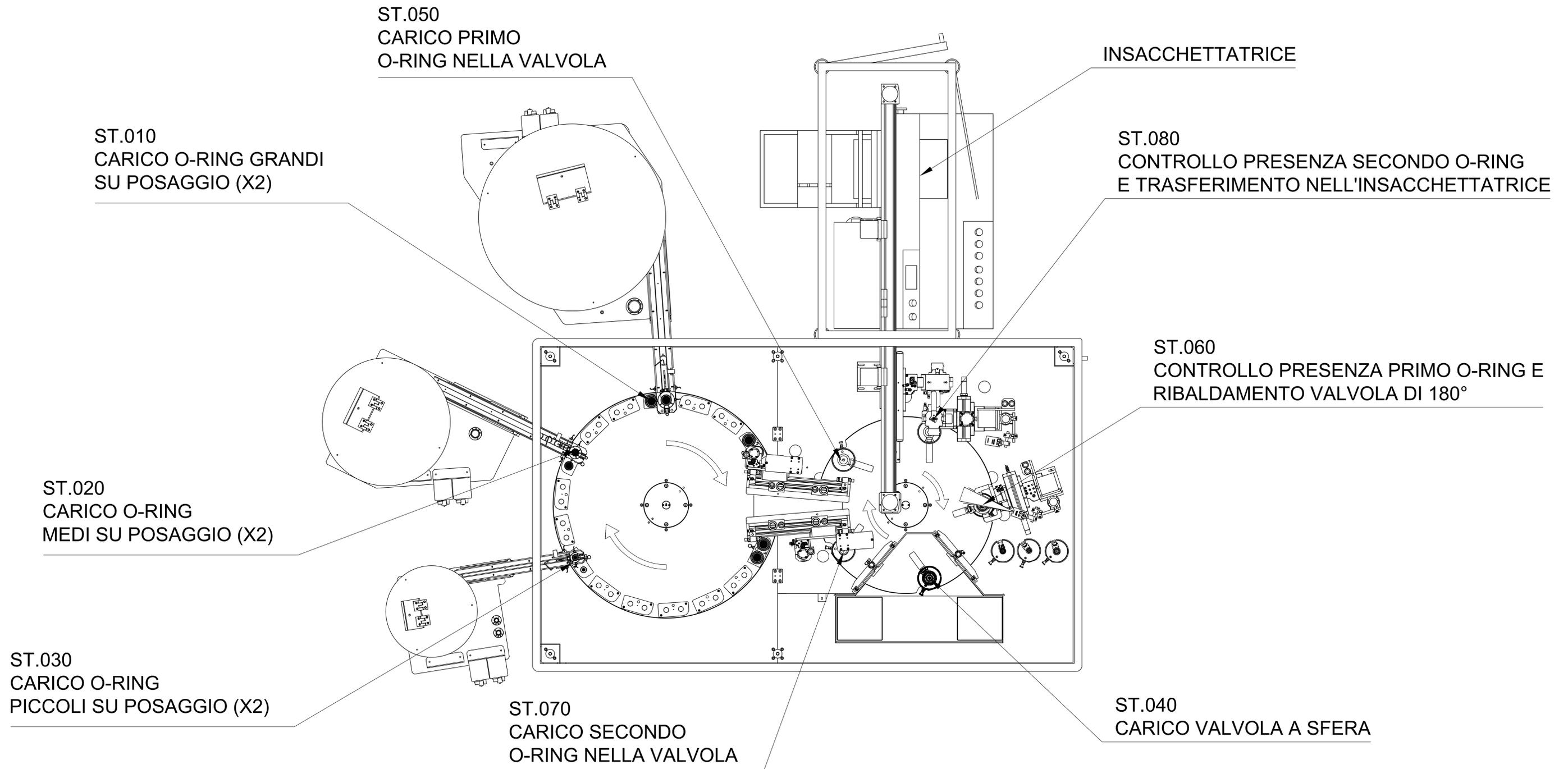
**IMPIANTO AUTOMATICO DI ASSEMBLAGGIO O-RINGS INTERNI
