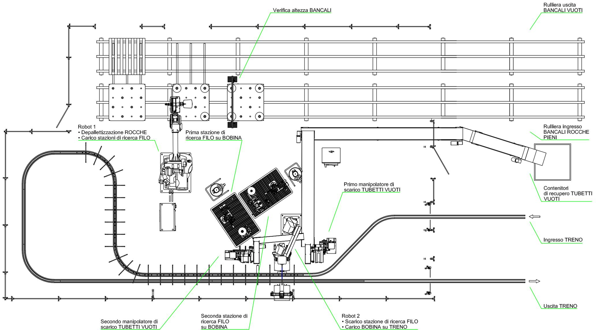
**IMPIANTO AUTOMATICO DI ASSERVIMENTO CANTRE PER TUFTING MACCHINE
