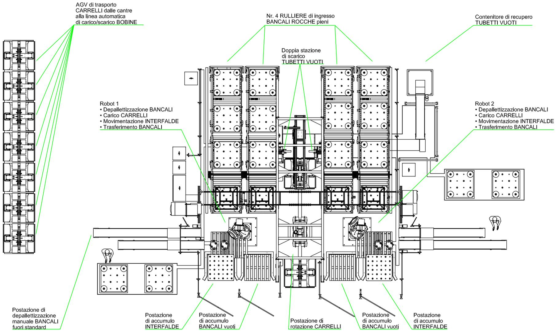
**SISTEMA AUTOMATICO DI ASSERVIMENTO CANTRE PER MACCHINE TUFTING
